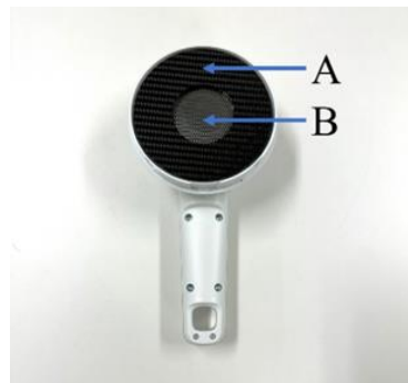
図 8 サーバイメータの全体像 A : 半導体検出器の固体センサー, B : GM 管
