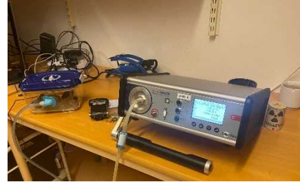
図3 ラドン鉱石からのアルファ線測定の様子
